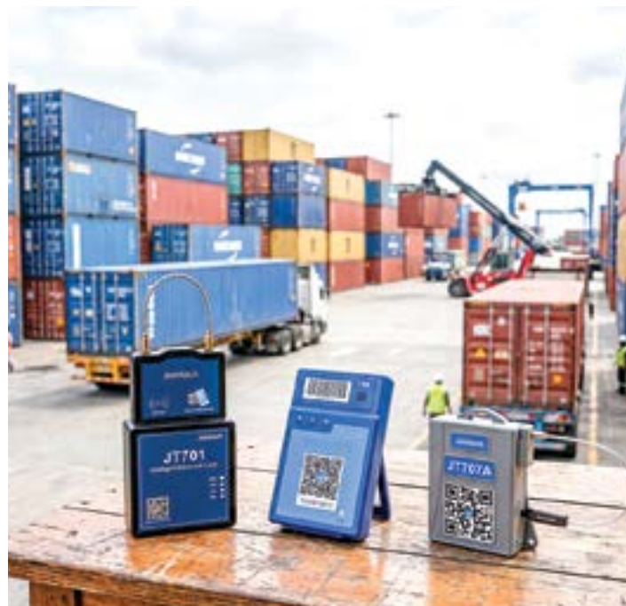
» En el centro, un dispositivo de rastreo portátil (tracker GPS); en las esquinas, candados electrónicos satelitales.
